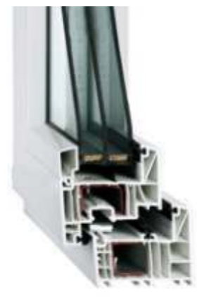
Kunststofffenster mit 6-Kammer-Profil und 3-fach Isolierverglasung, U_G=0,5 \text{ W/(m}^2\text{K)} , weiß
