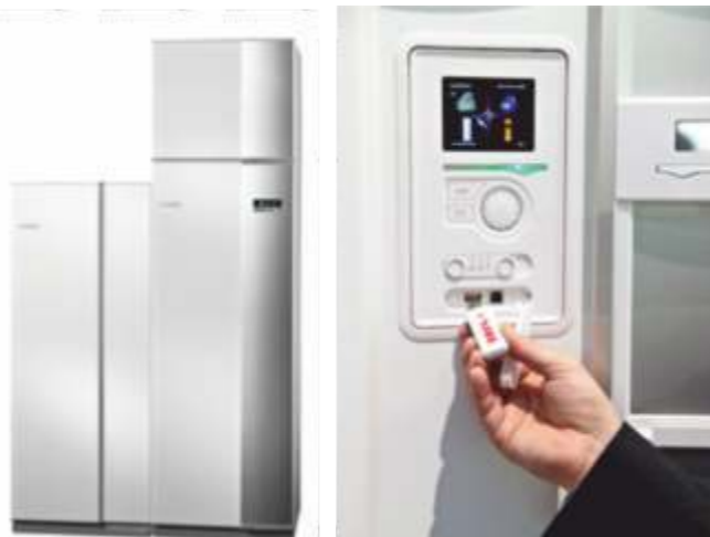
Technikpaket 3B Abluftwärmepumpe mit separatem 200-Liter-Warmwasserspeicher und integrierter Lüftungsanlage (Zuluft dezentral, Abluft zentral mit Wärmerückgewinnung)
